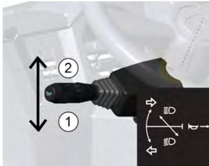
Zum Abschalten des Blinksignals den Hebel wieder in Mittelstellung bringen.
