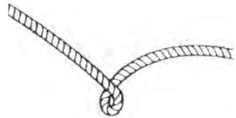
Auf der Abbildung rechts ist ein eingeknicktes Windendrahtseil zu sehen, das gerade gebogen wurde. Es mag zwar brauchbar aussehen, ist jedoch irreparabel und schwer beschädigt. Es ist nicht mehr in der Lage, die Last zu übertragen, der es im intakten Zustand standhalten konnte. Ein Windenseil in diesem Zustand darf nicht mehr benutzt werden.
