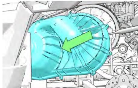
2. Die Abtriebskupplung drehen und den Riemen in die Kupplung einlegen.
