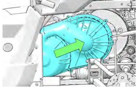
8. Die äußeren Kupplungsdeckelschrauben montieren und mit dem vorgeschriebenen Drehmoment anziehen.
