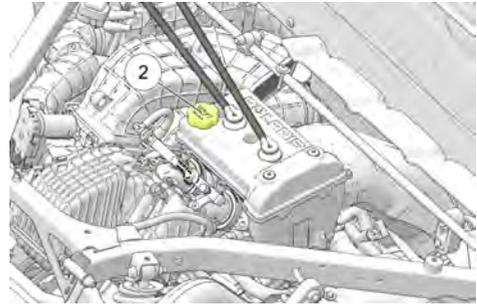
Der Ölmesstab befindet sich am Motor. Der Ölmesstab ist durch den rechten Hinterradkasten zugänglich.
