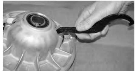
Zum Auseinanderspreizen der Riemenscheiben Druck auf das andere Ende des Werkzeugs ausüben.
